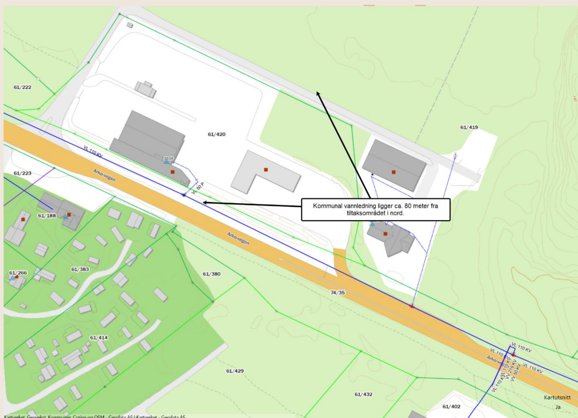
Figur 13: Utsnitt over eksisterende 110 vannledning langs Arko-Vegen.
