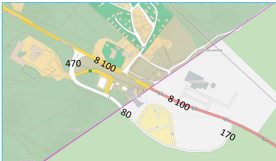
Figur 18: Trafikkmengder på nærliggende veier.
